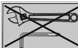
Ziehen Sie nicht alle Muttern und Schrauben in diesem Schritt fest.
